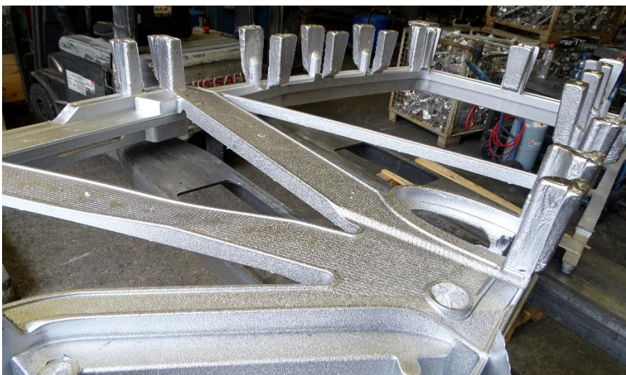
Рис. 7: Введение вафельной структуры и дополнительных вентов позволило устранить дефекты литья
